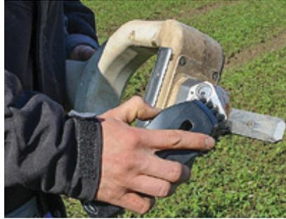
△ Zwischen den Messungen muss man den Sensorkopf mit einer Bürste reinigen.
