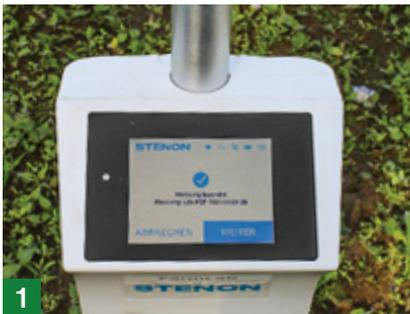
1  $\Delta$  Unterhalb des Griffs befindet sich die Bedieneinheit mit Touchscreen.
