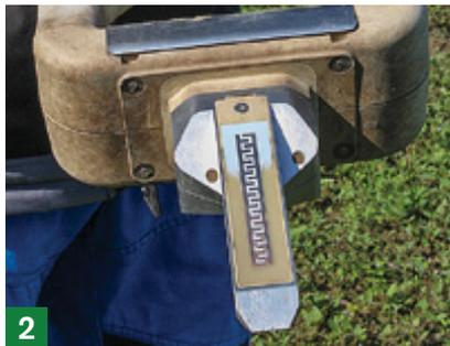
2  $\Delta$  Die Messeinheit, die in den Boden gestochen wird, ist mit elektronischen Sensoren...
